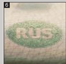
12. Металлографская печать цветопеременной краской а) вид под прямым углом; б) вид под острым углом
