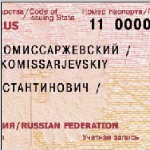
2. Персональные данные, фотография, серия и номер паспорта, подпись владельца паспорта нанесены методом лазерного гравирования
